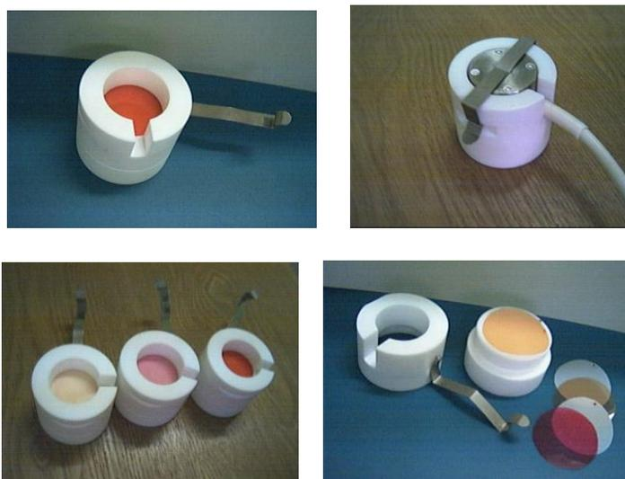
**Рис. 4.2** Внешний вид и конструкция разработанных имитационных мер для калибровки и поверки неинвазивного тканевого оксиметра «Спектротест».
