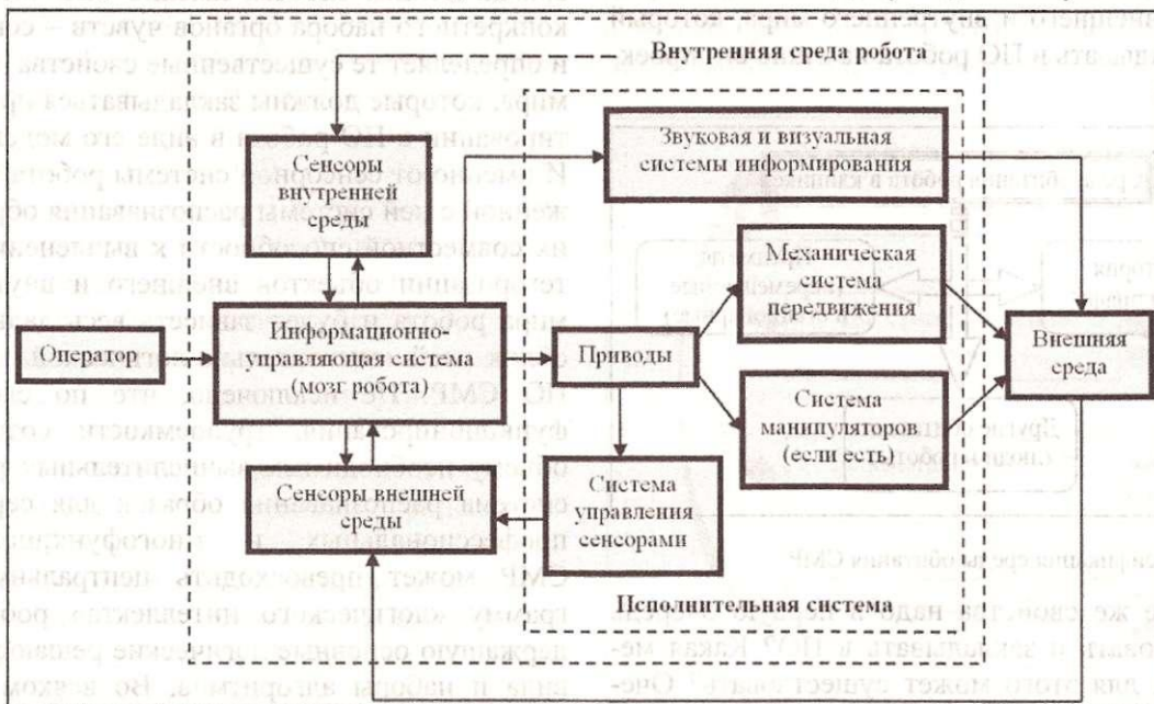
Рис. 3. Обобщенная структурная схема рассматриваемых СМР
