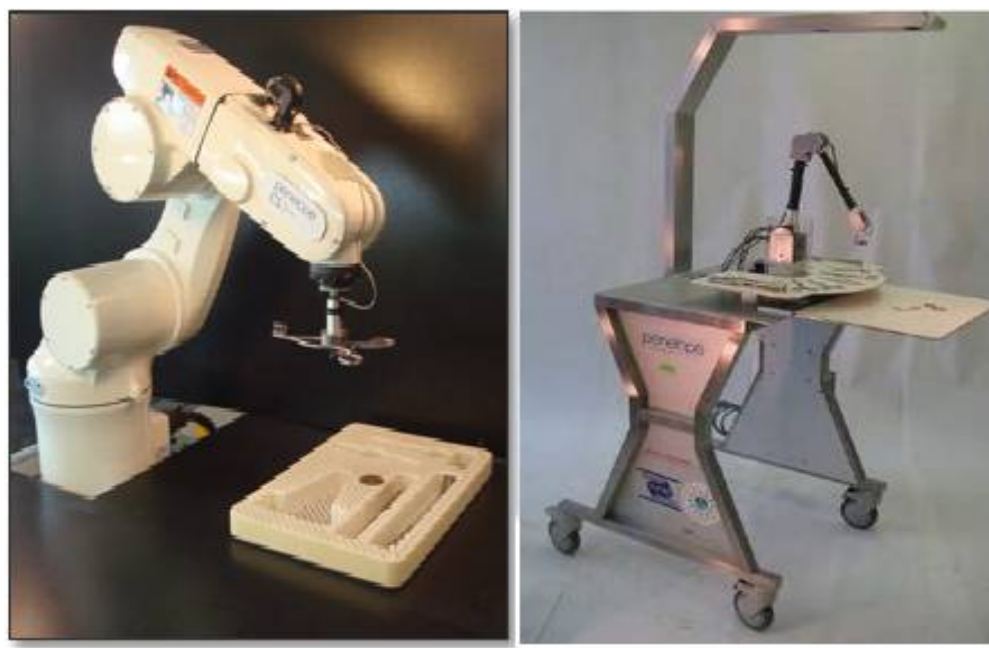
Рис. 6. Робот помощник хирурга для подачи инструмента «Пенелопа».
