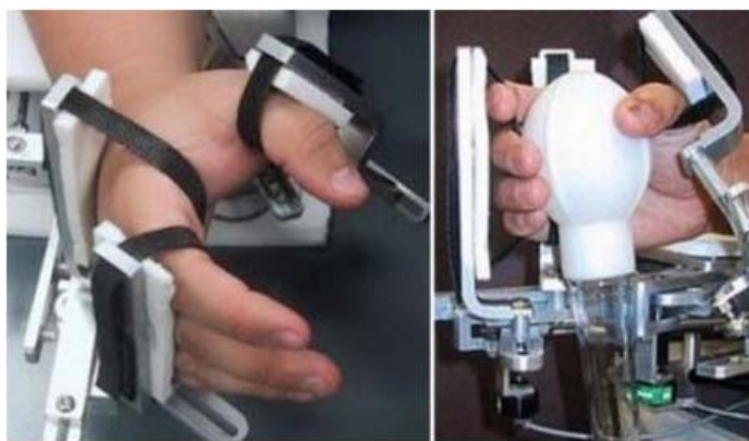
Рис. 8. Роботизированное устройство для реабилитации больных после инсульта.
