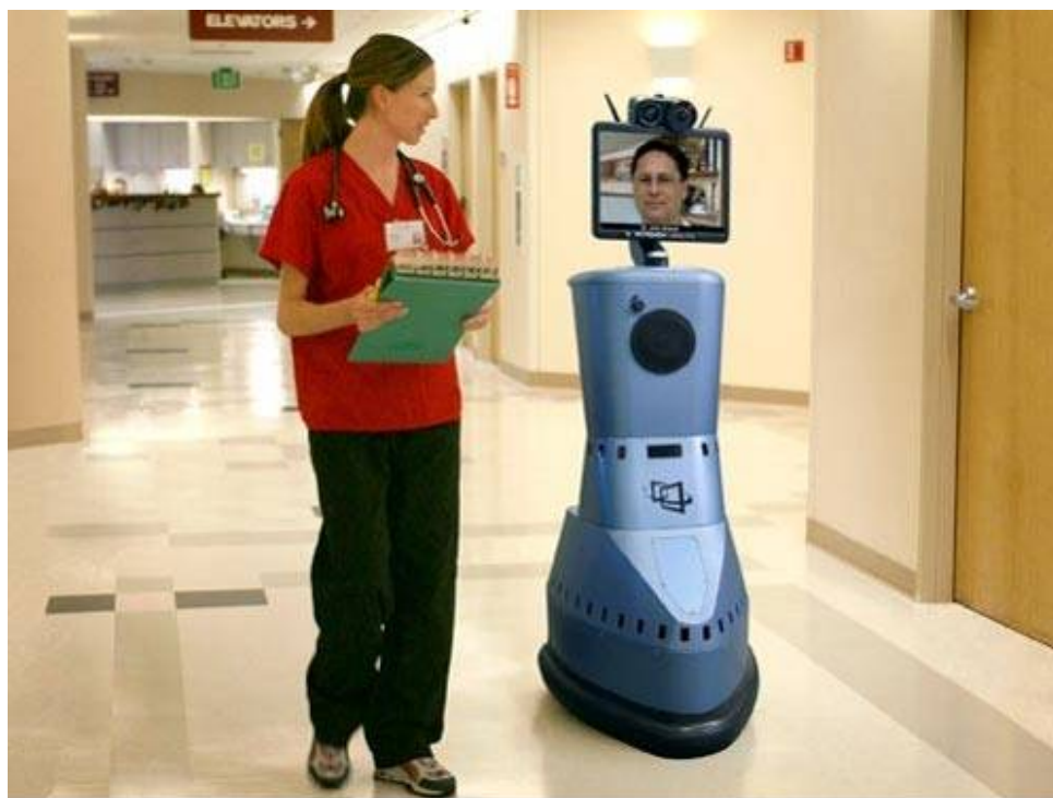
Рис. 3. Доктор робот «Бари» (проект “RP-7”).
