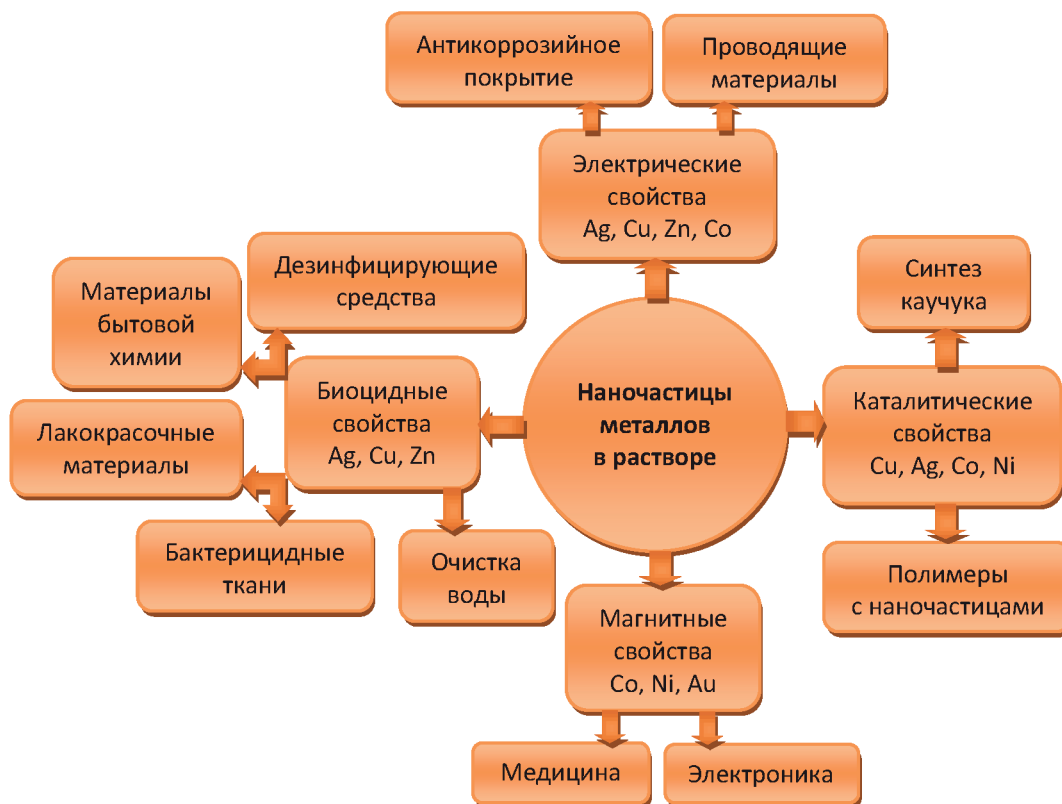
Рис. 2. Использование наночастиц металлов в растворах
