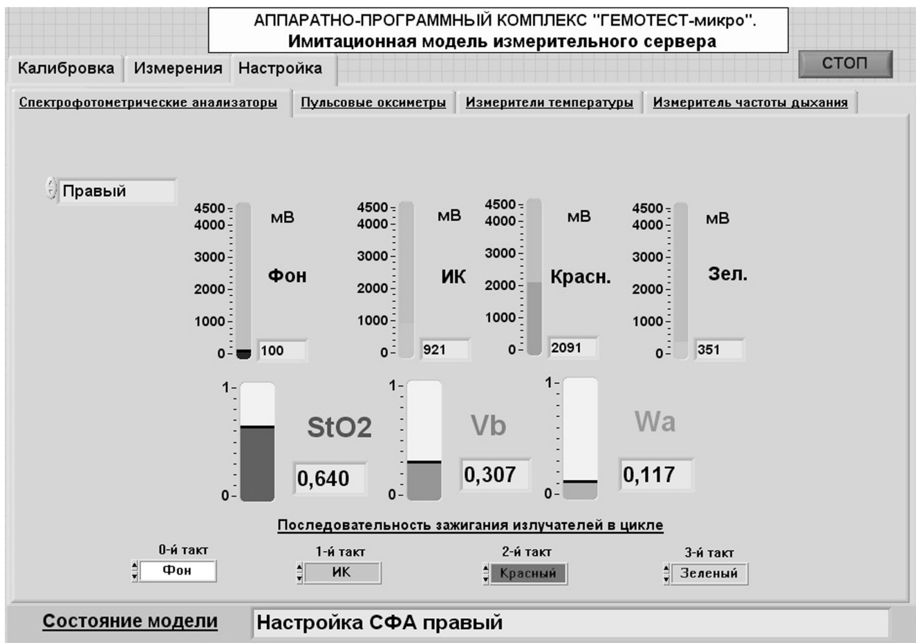
Рис. 5. Интерфейс пользователя имитационной модели измерительного сервера, работающего в режиме настройки правого спектрофотометрического анализатора
